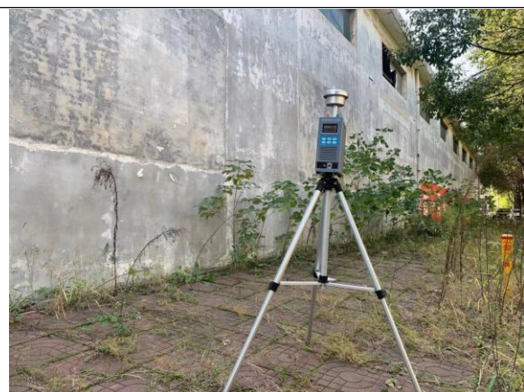
无组织废气采样照片 2
