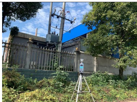
无组织废气采样照片 1
