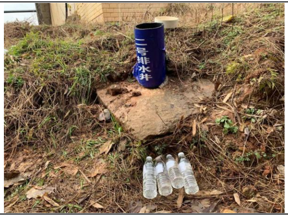
U2 地下水采样照片
