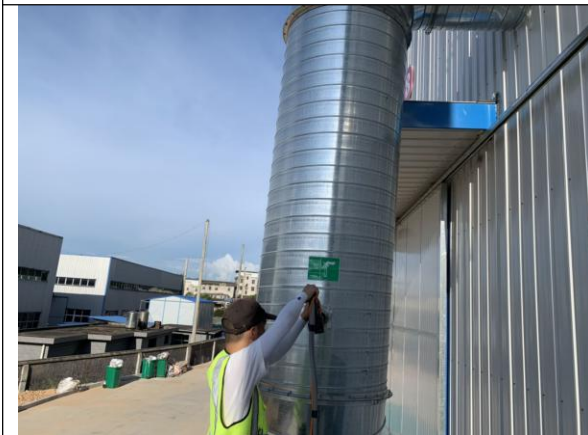
喷涂废气进口采样照片
