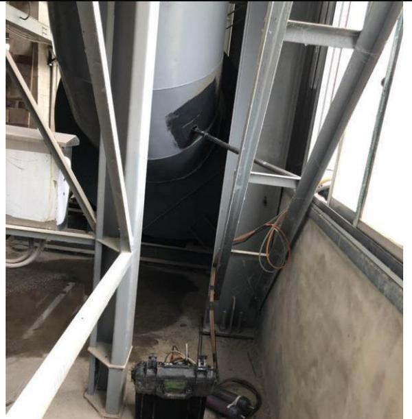
有组织废气出口采样照片
