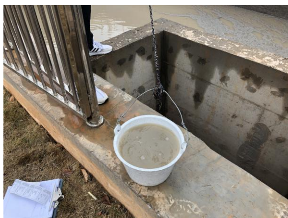
废水采样进口
